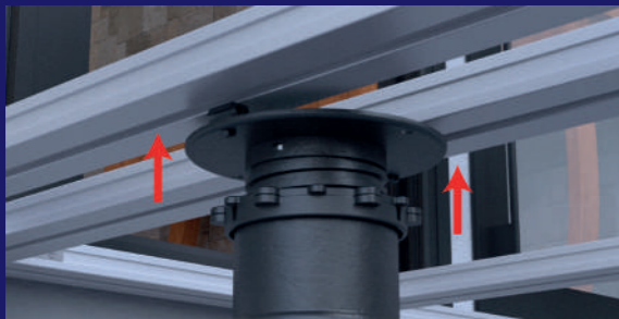
3º Colocación de plots
