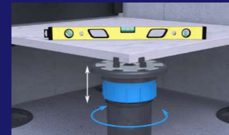
4° Nivelado de baldosa
